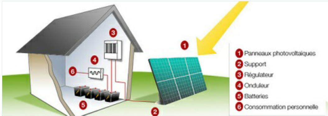
Figure 4.28 : Une installation photovoltaïque en site isolé
