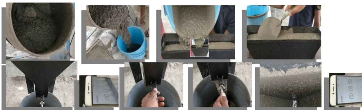
Fig. 11. Etapes du déroulement du test à l'entonnoir 'V-Funnel' (du remplissage de l'entonnoir jusqu'à l'écoulement total du béton à travers la trappe).
