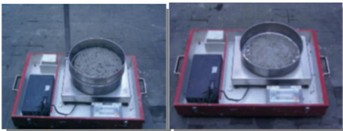
Fig. 12. Schéma et photographie [28] descriptifs du test de stabilité au tamis (GTM).
