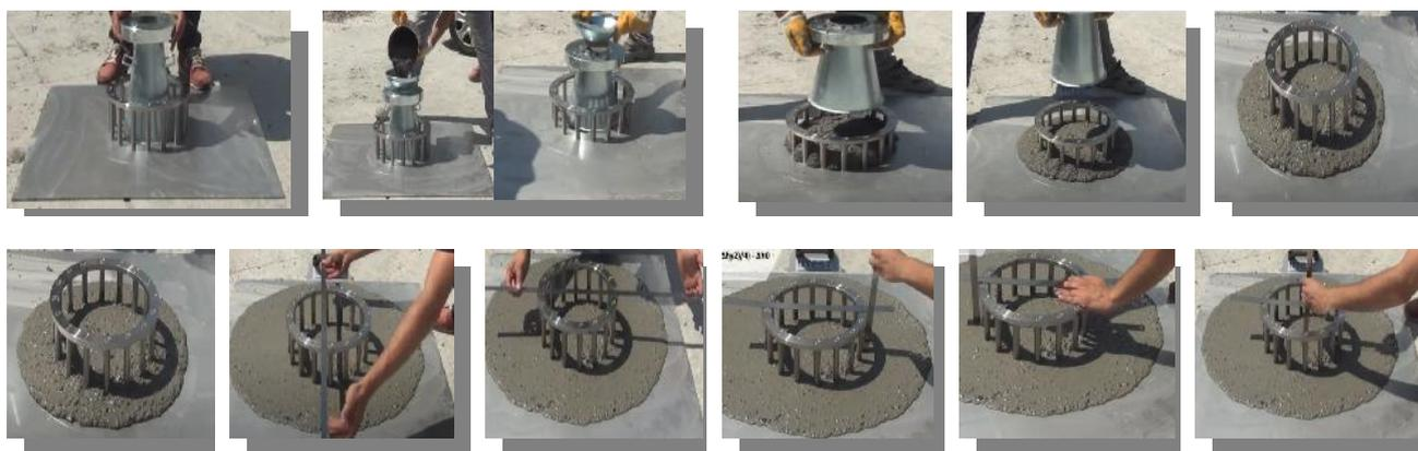
Fig. 7. Étapes du déroulement du test d'étalement à l'anneau (du remplissage du cône jusqu'à l'étalement de la galette du béton auto-plaçant sur le plateau avec l'anneau J-Ring).
