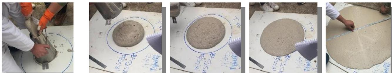
Fig. 4. Etapes du déroulement du test d'étalement (du remplissage du cône jusqu'à l'étalement de la galette du béton auto-plaçant sur le plateau)
