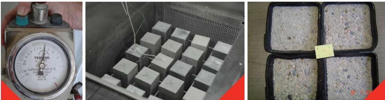
Figure 36 : Contrôle de la teneur en air à l'aéromètres – Essai de gel interne - Essai d'écaillage [11]
