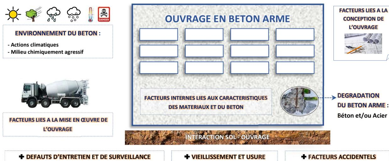
Figure 1 : Origines des désordres et dégradations dans les ouvrages en Béton Armé (BA)
