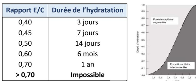
Figure 4 : influence du rapport E/C et du degré d'hydratation sur la continuité des pores capillaires [1]
