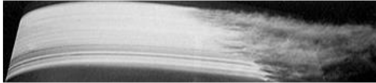
Figure 5.13. Transition de l'écoulement laminaire devient turbulente
