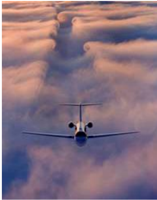
Figure 4.7. Déflexion vers le bas du flux d'air.
