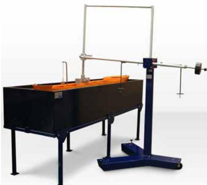
**Figure 5.1** Vue générale du banc d'essai avec le dynamomètre
