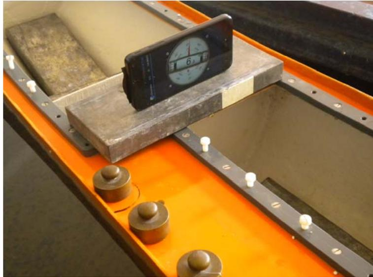
Figure 5.9 Position verticale du smartphone sur le modèle du navire
