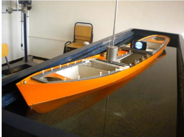
**Figure 6.2 Poids couissant le long du mât simulant différent  $GM$**
