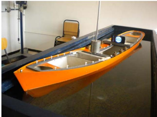
**Figure 5.2** Vue générale du banc d'essai avec le smartphone
