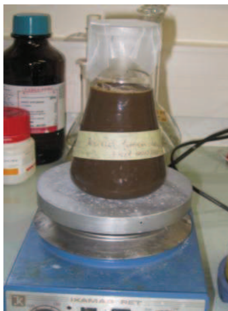
Figure IV.14 : Préparation de lixiviat de terreau de jardin.
