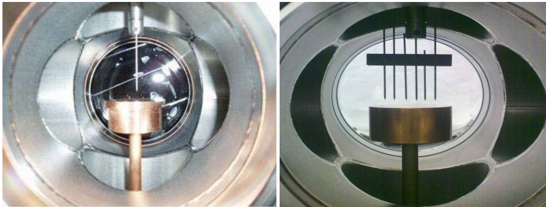
Figure II.6 [2, 12]: Photographie de la cellule de décharge mono et multi-pointes plan
