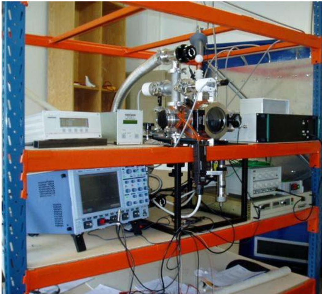
Figure II.1 [12]: Photographie du dispositif expérimental du réacteur à décharge couronne mono et multi-pointes plan.
