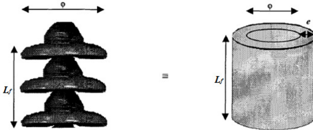
Figure I.2 Assimilation théorique d'un isolateur à un cylindre
