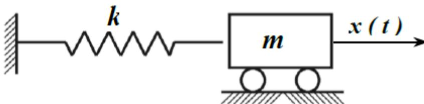
Figure 4.1 : Système non amorti
