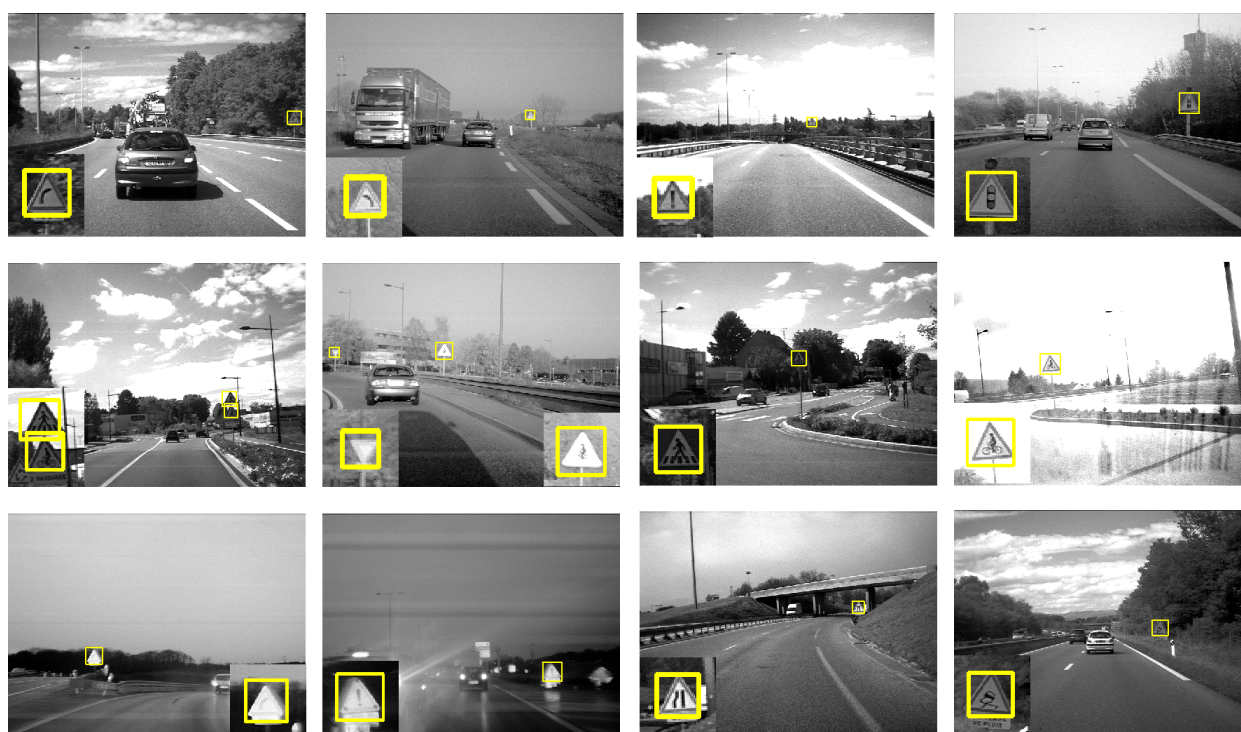
FIGURE 3.19 – Exemples de Détection de panneaux de danger.
