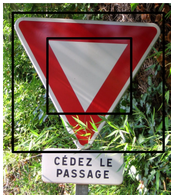
FIGURE 2.28 – Détection des formes triangulaires d’un panneau de cédez le passage.
