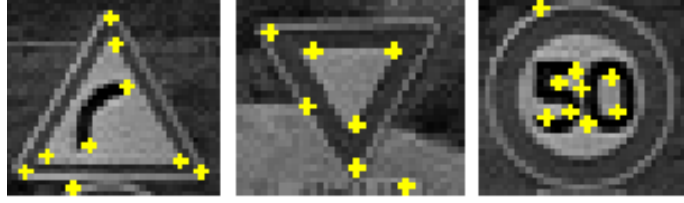
FIGURE 3.1 – Détection des points d'intérêt liés aux panneaux.
