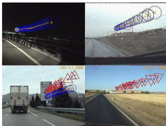
FIGURE 2.24 – Exemple du suivi temporel de panneaux routiers [Garcia-Garrido et al. , 2006].
