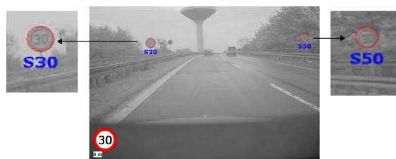
FIGURE 2.25 – Exemple de fusion de panneaux identiques par l'approche Bayésienne [Meuter et al. , 2011].
