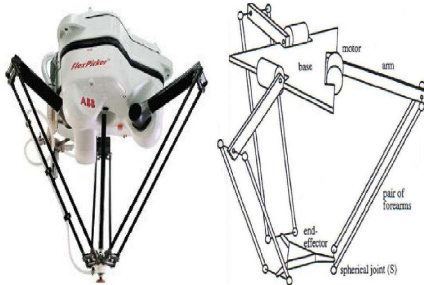
Figure 1.12 FlexPicker ABB (Version industrielle du robot Delta)
