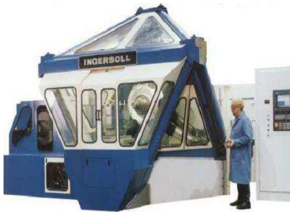
Figure 2.9 (a) Machine-outil basée sur une plate-forme de Gough (Ingersoll, USA) [15]
