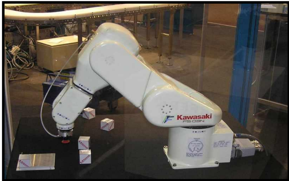
Figure I.1: Un robot industriel Kawasaki FS-03N, robot de soudage.
