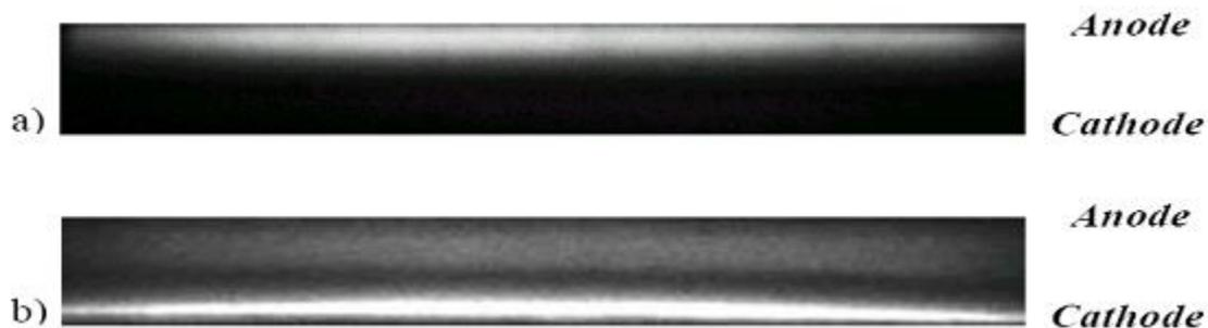
**Figure I-10** : Photographie de l'espace inter-électrode d'une décharge homogène a) dans azote.
