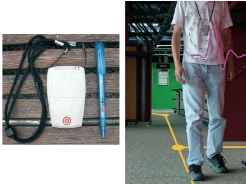
Figure 1.4 : Emetteur mobile ULB de la société Ubisense [12].
