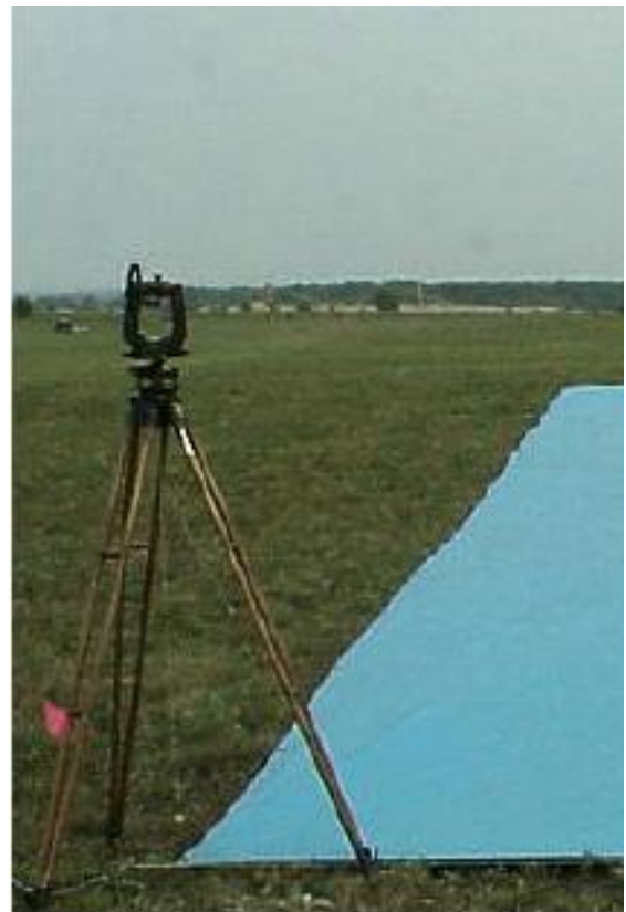
(B) Chaque point de participation a été aligné par un transit pour obtenir une ligne aussi droite que possible.
