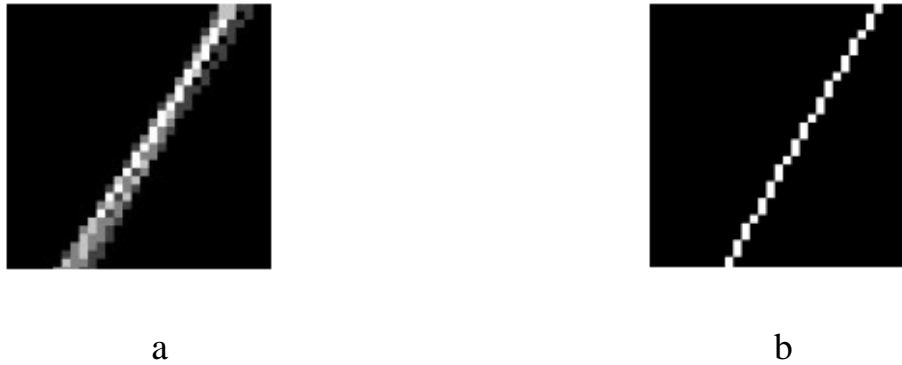
Figure 3.22 : a) contour reconstruit après le seuillage dans l'espace de Hough, b) contour reconstruit après seuillage de l'image a.
