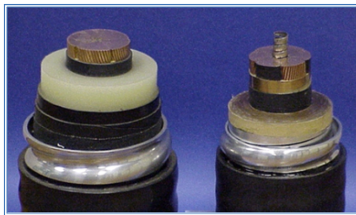
Fig.4.6. Câble de 400-kV AC à isolation solide extrudée (à gauche), et à l'isolation en papier imprégnée a l'huile (à droit).
